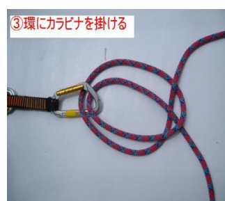
(図ー5 クローブヒッチ、両手で作れる場合)
