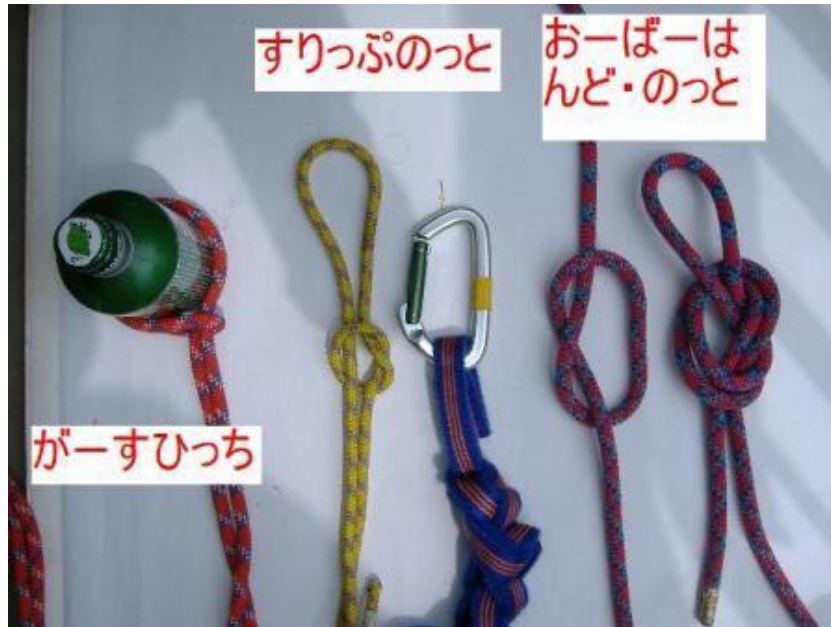
(図—19～21 ガースヒッチ、スリップノット、オーバーハンドノット)
